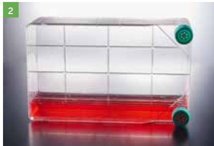
2 Уравновесьте, положив систему Cell Factory на бок со стороны небольшого отверстия
