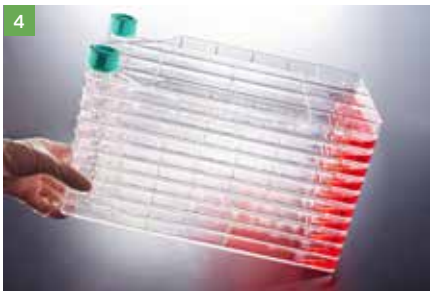
4 Осторожно наклоните систему Cell Factory в горизонтальное положение для инкубации, при этом отверстие для наполнения должно быть обращено вверх
